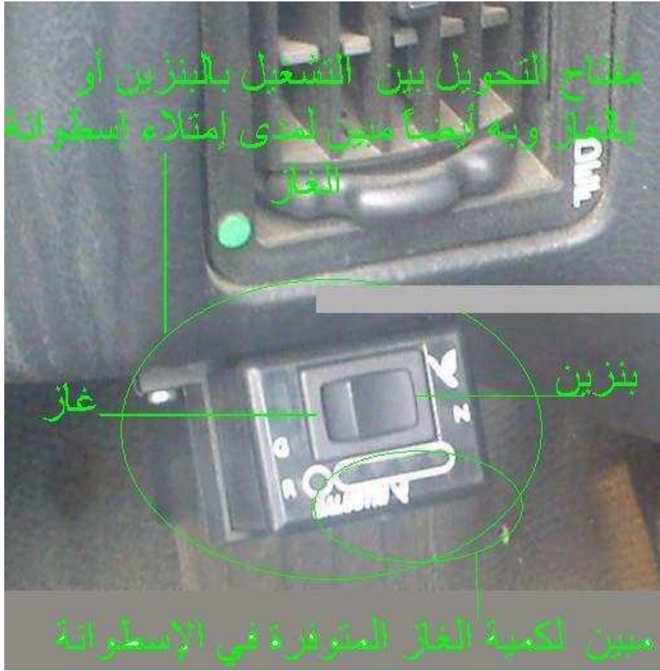
الشكل (١٠-٢) مفتاح التحويل بين التشغيل بالبنزين والغاز الطبيعي
