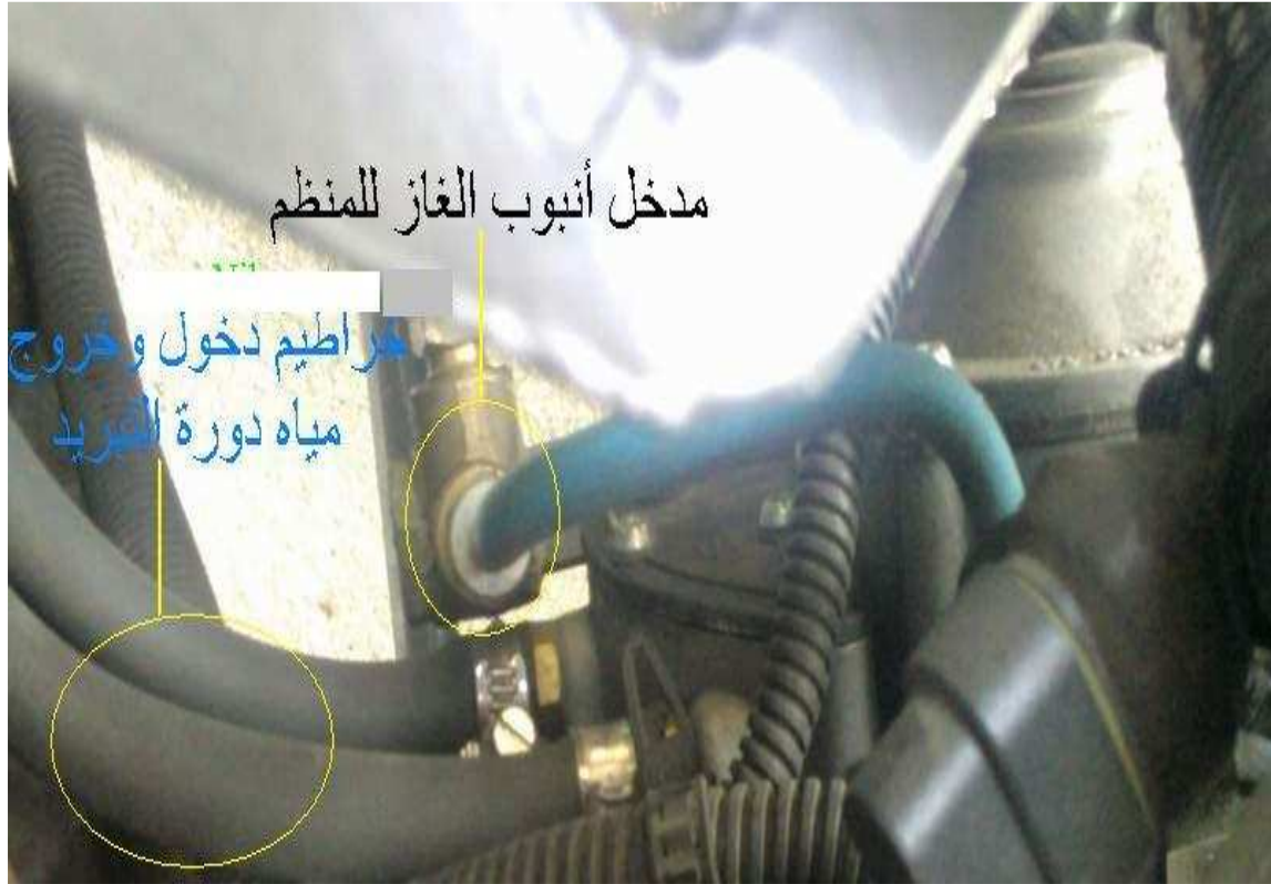
الشكل (٥-٢) توصيل دائرة التبريد الخاصة بالسيارة بالمنظم الخاص بالغاز
