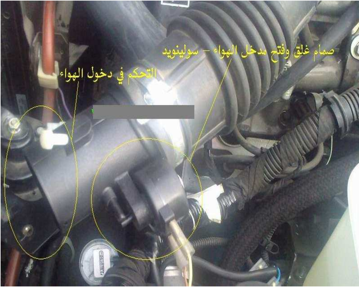
الشكل (٧-٢) توضع صمام التحكم بدخول الهواء قبل فلتر الهواء
