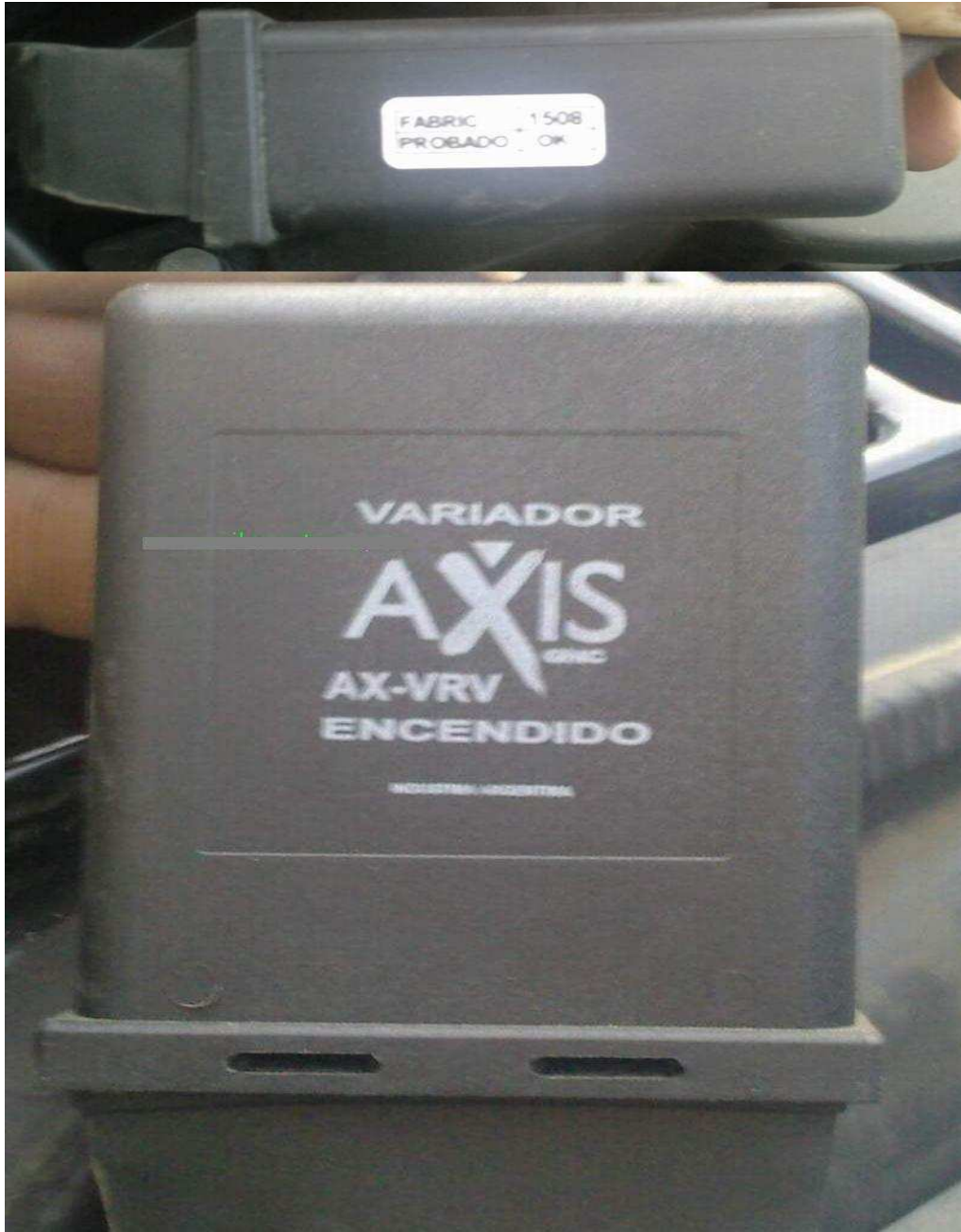
الشكل (٨-٢) توصيل الجهاز الكهربائي الخاص بضبط مقدار الضغط على دواصة البنزين
