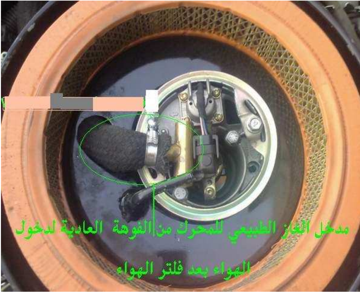
الشكل (٦-٢) توصيل فتحة دخول الغاز للمحرك
