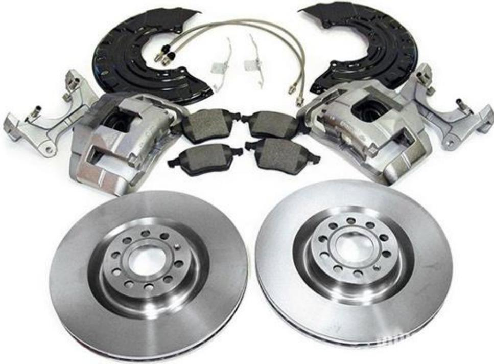
تسمى الفرامل القرصية بهذا الاسم لأنها تستخدم القرص الدوار (يطلق عليه قرص الفرامل أو الطنابير)، حيث تتصل عجلة السيارة بالقرص الدوار، وبالتالي يعتمد هذا النظام على فكرة أن إيقاف القرص سيقوم أيضاً بإيقاف العجلات، وينقل نظام الفرامل القرصية قوة التوقف من خلال الأسلاك الهيدروليكية إلى بطانة الفرامل (التيل)، والتي تضغط على الأقراص الدوارة، ويؤدي هذا الاحتكاك بين تيل الفرامل والطنابير إلى إبطاء حركة عجلات السيارة حتى توقفها.
