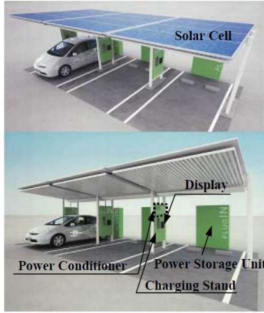
الشكل (٢) : مكونات نظام الشاحن الكهروضوئي.
